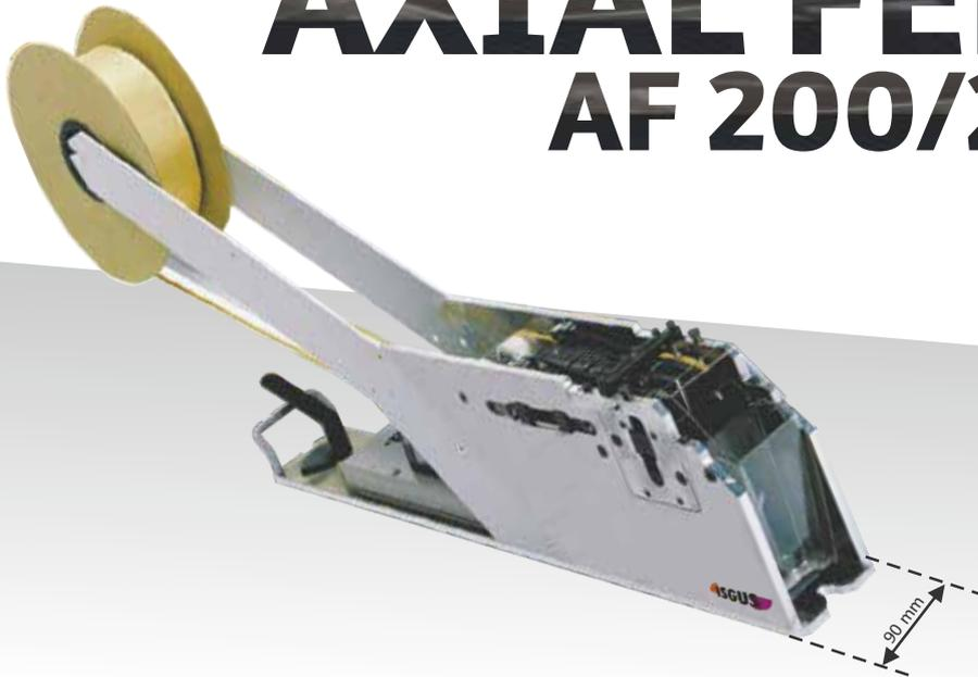
**Axial Feeder AF 200/201, die automationsgerechte Zuführung für Axial-Bauteile. Kurze Umrüstzeiten durch Austauschbarkeit der Geräte sorgen für geringe Maschinenstandzeiten.**
